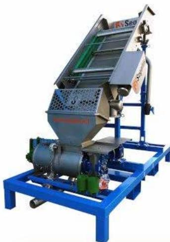
42. Rampa separadora combinada con separador de tornillo
