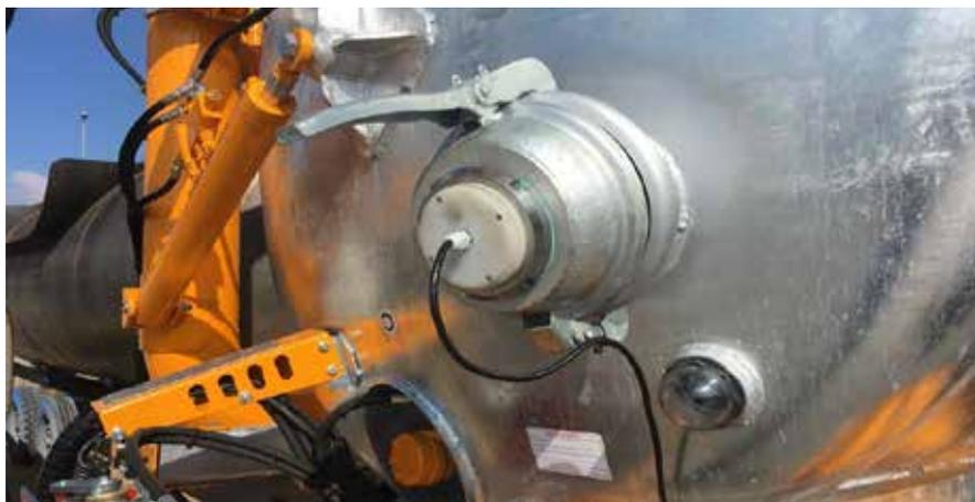
21. Conductímetro instalado en la cisterna
